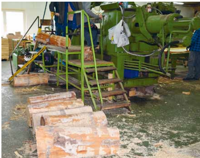
Obrázek 3.45: Březové výřezy připravené pro loupání dýhy (rodinná firma na loupání dýhy a výrobu překližkových nábytkových dílů, poblíž Nysy, Polsko). Foto: Milan Košulič
